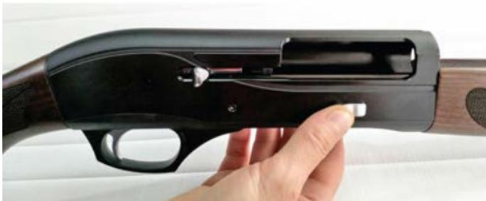
При нажатии кнопки затворной задержки без установленного ствола, рукоятка затвора ударится о переднюю часть окна для выброса, и ствольная коробка будет повреждена.
