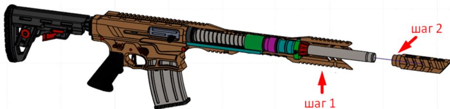
**ШАГ 1:** ПОВОЕРНИТЕ ФИКСИРУЮЩУЮ ГАЙКУ ЦЕВЬЯ ПРОТИВ ЧАСОВОЙ СТРЕЛКИ, ТАК КАК ЭТО ПОКАЗАНО ВЫШЕ НА РИСУНКЕ.
