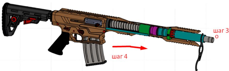
**ШАГ 3:** В УПАКОВКЕ С ВАШИМ РУЖЬЕМ НАХОДЯТСЯ ОДИН ГАЕЧНЫЙ КЛЮЧ ДЛЯ ЦЕВЬЯ И ОДИН МНОГОФУНКЦИОНАЛЬНЫЙ КЛЮЧ F12. ИСПОЛЬЗУЙТЕ ЭТИ КЛЮЧИ ДЛЯ ОСЛАБЛЕНИЯ ФИКСИРУЮЩЕЙ ГАЙКИ ЛОЖИ.
